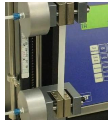
Fig. 2 : Essai d'étirage d'un film
