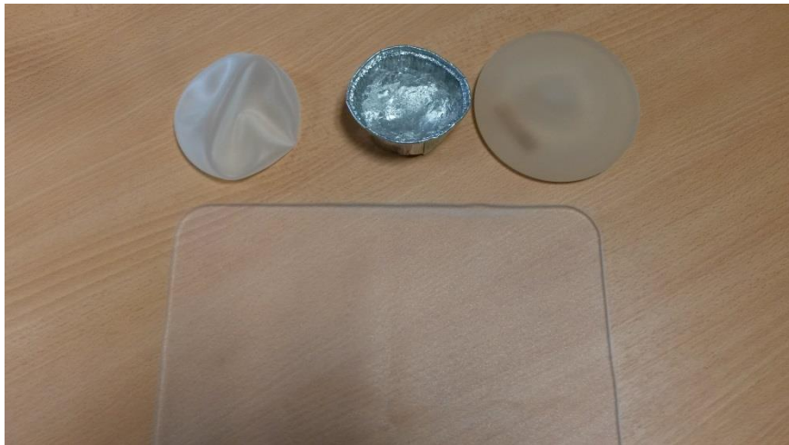
Fig. 1 : Prothèse mammaire constituée d'une enveloppe et d'un gel en élastomères de silicone
