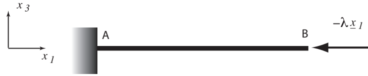
FIG. 4 – Poutre à section rectangulaire, de longueur L , encastrée en A et soumise a un effort longitudinal en B.
