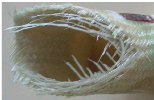
Fig. 1 Tube composite rompu faisant apparaître les angles d'enroulement du renfort. D'après [Mercier, 2006].
